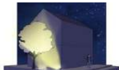
Éclairage très mauvais : le flux est dirigé du bas vers le haut et éclaire la végétation. Il y a une forte nuisance sur la végétation et la faune hébergée ainsi qu'une forte pollution lumineuse.
