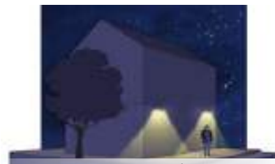
Éclairage bon : le flux est dirigé du haut vers le bas, la végétation n'est pas éclairée et la pollution lumineuse est limitée.
